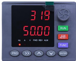
图 3-2 停机参数显示状态 显示停机时的设定频率“50.00”
