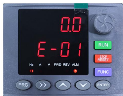
图3-4 加速中过流故障报警显示
