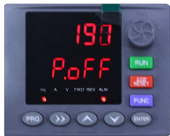
图 3-1 上电参数显示状态 上电初始化，显示“P.oFF”
