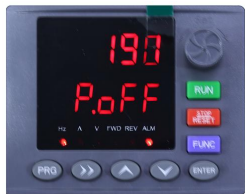
图 3-1 上电参数显示状态 上电初始化，显示“P.oFF”
