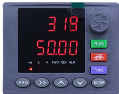
图 3-2 停机参数显示状态 显示停机时的设定频率“50.00”
