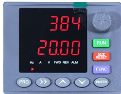
图 3-3 运行参数显示状态 显示运行时的输出频率“20.00”
